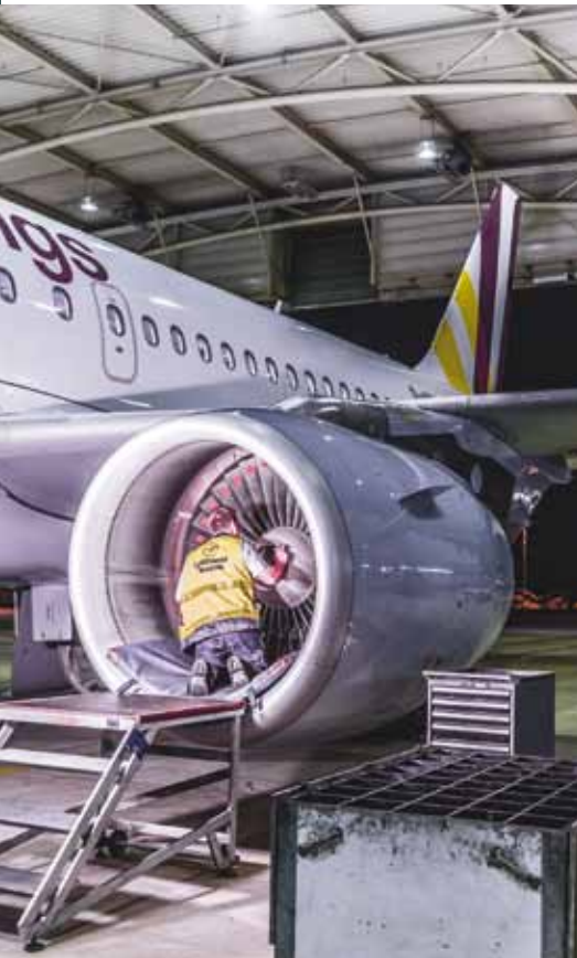
Die Turbinen der Flugzeuge werden regelmäßig geprüft. Der Mechaniker baut dazu alle Blätter einzeln aus.
