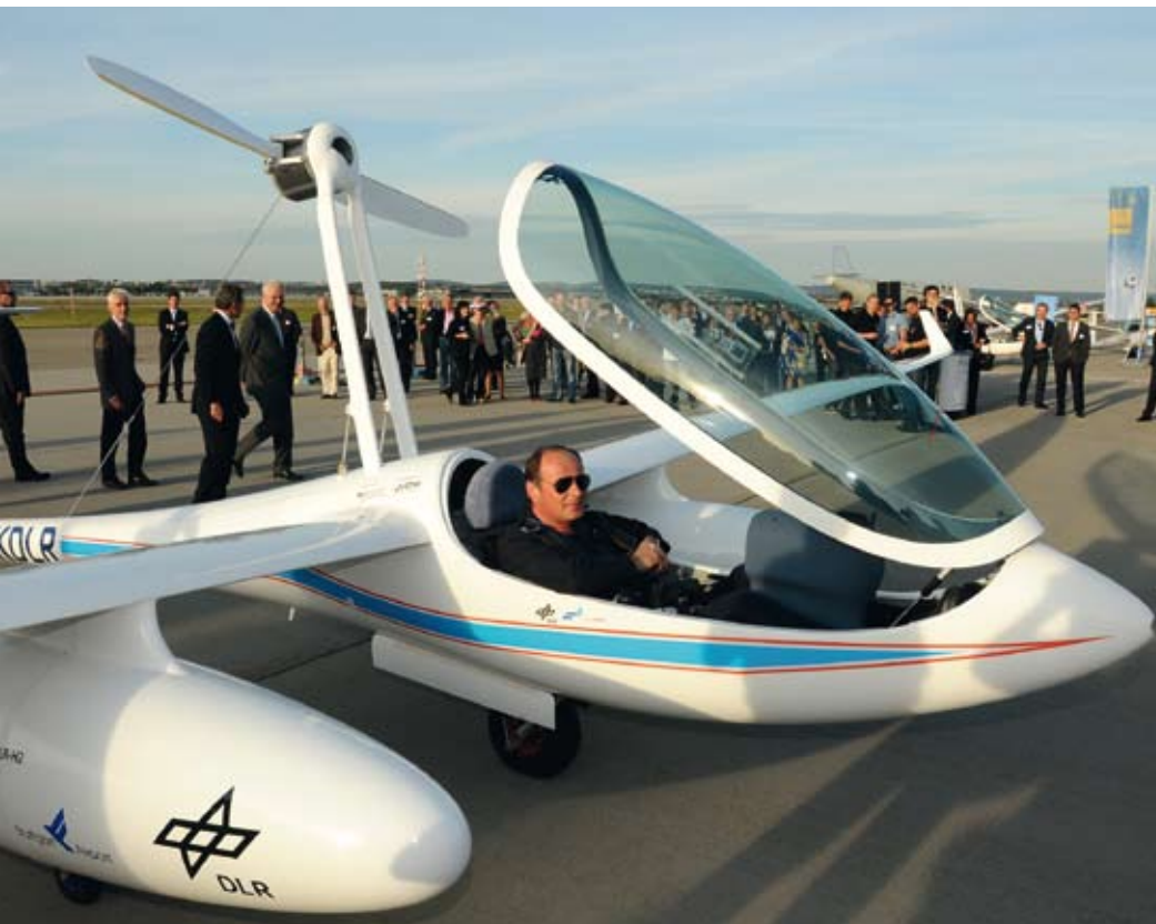
Klein und vor allem lautlos landete die Antares DLR-H2 am Flughafen Stuttgart. Dank des Brennstoffzellenantriebs ist die Maschine leise und emissionsfrei unterwegs. Das bewies der Flieger auch bei der Veranstaltung am Airport vor zahlreichen Gästen.
