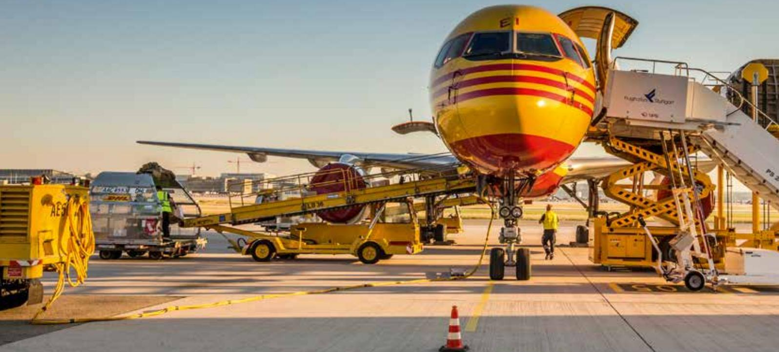
Bei Sonnenaufgang sind die Vorfeldmitarbeiter schon längst unterwegs. Links im Bild räumen sie einzelne Kisten aus dem Bauch der DHL-Maschine und verstauen sie in Gepäckwagen, rechts rollen ganze Alu-Container auf das Hubgerät.
