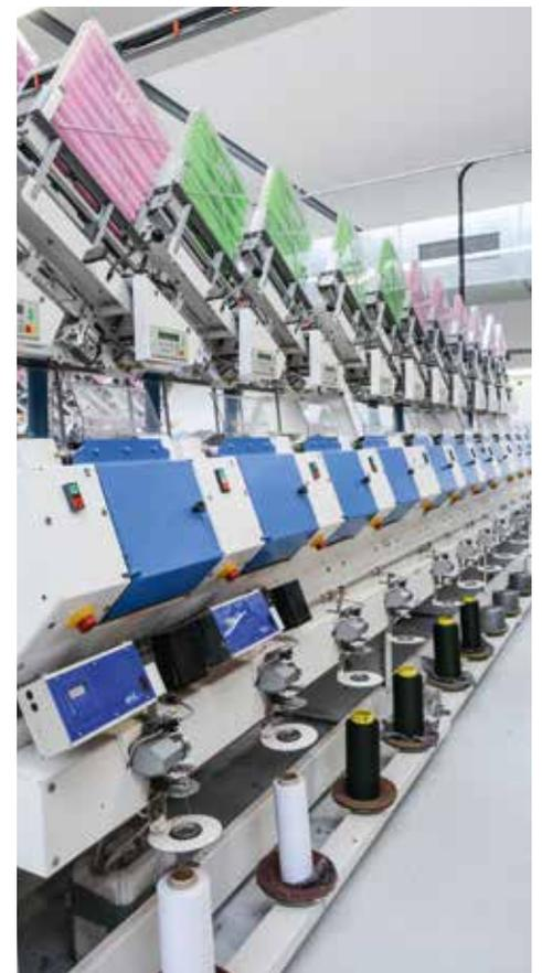
*Fäden ab auf die Rolle: Die sogenannte Aufmachungsmaschine sorgt dafür, dass dies in Windeseile geschieht.*
