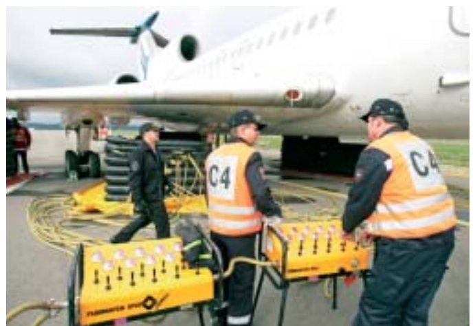
Die Seminarteilnehmer ziehen alle Register der Technik, um die großen Hebekissen mit Luft zu füllen
