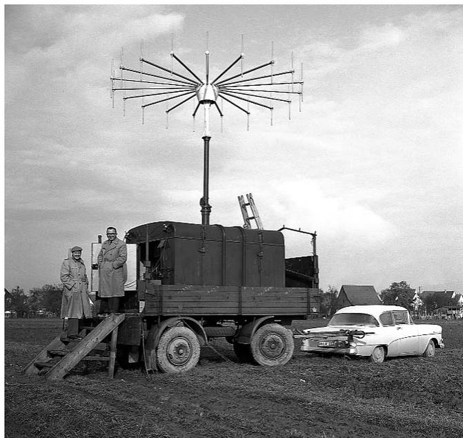
*High-Tech in Kinderschuhen: In den fünfziger Jahren wurde das ILS nicht mit Vermessungsflügen, sondern mit Hilfe eines mobilen Peilers kontrolliert.*
