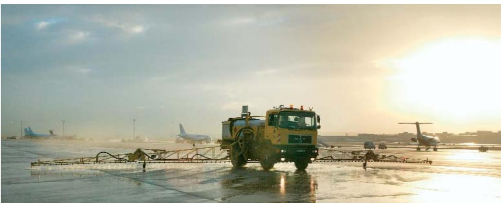
Über 24 Meter Breite kann der Sprühwagen auf der Piste Antifrostmittel verteilen.
