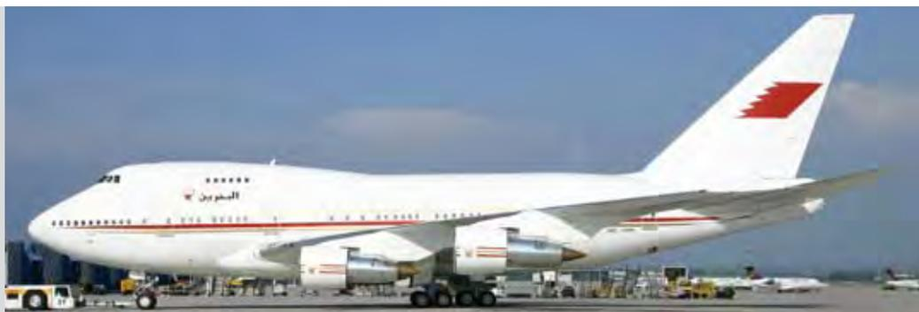
Die Boeing 747SP ist gegenüber der „normalen“ Boeing 747 knapp 15 Meter kürzer und fällt durch ihre gedrungene Form auf. Ursprünglich als Variante für Langstrecken mit geringerer Nachfrage konzipiert, wird sie heutzutage fast ausschließlich als VIP-Flugzeug eingesetzt. Die Flotte des Königs von Bahrain verfügt neben weiteren Flugzeugtypen lediglich über dieses eine Exemplar.
