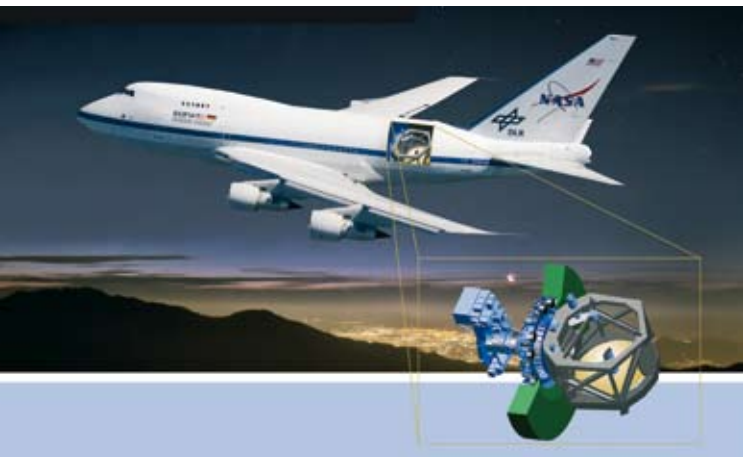
Im hinteren Teil der Boeing 747 befindet sich das in Deutschland gebaute Teleskop. Sein Hauptspiegel hat einen Durchmesser von 2,7 Metern.
