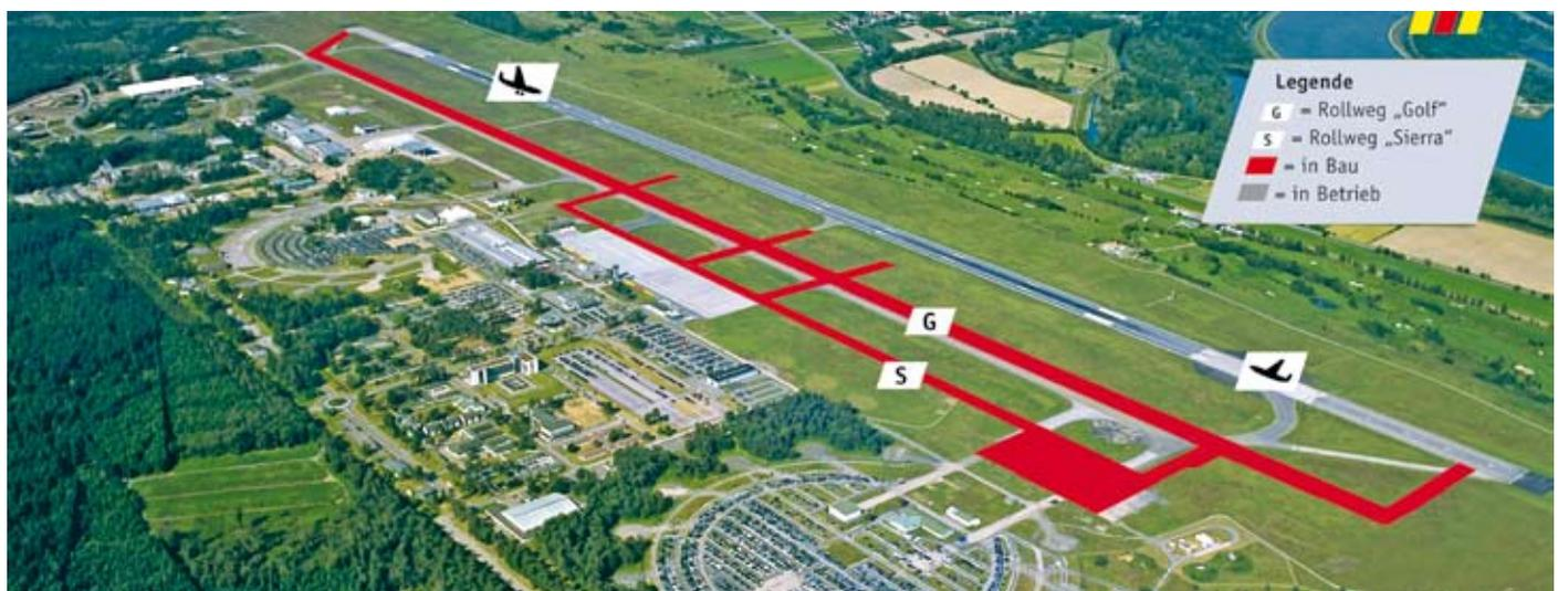
Der aktuelle Stand: Golf (G) wird ersatzweise zur Start- und Landebahn umgebaut und Sierra (S) wird zum dazugehörigen Rollweg. Wenn beides fertig ist, bekommt die eigentliche Piste den neuen Belag und ist dann fit für die kommenden Jahre.
