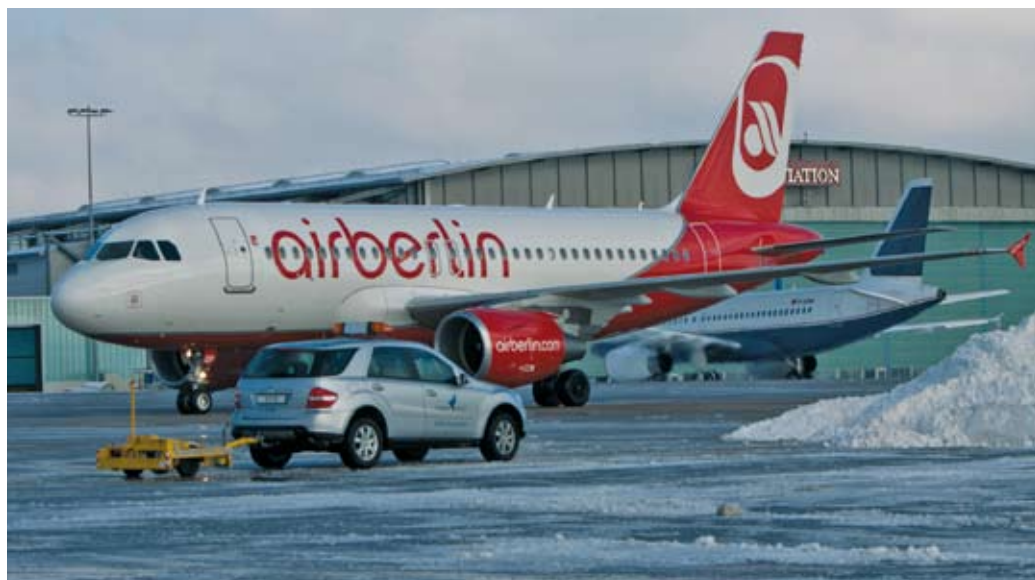
Ist es glatt oder nicht? Ob der Boden griffig genug ist, misst die Verkehrsaufsicht mit dem angehängten Skiddometer.
