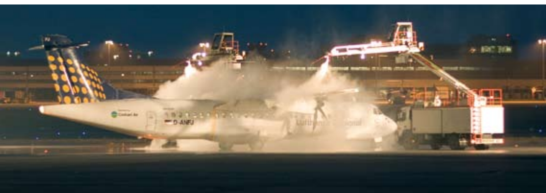
Schnelle Dusche: Damit Eis oder Schnee nicht am Flieger haften bleiben, spritzen sogenannte Elefanten die Maschinen vor dem Start ab.
