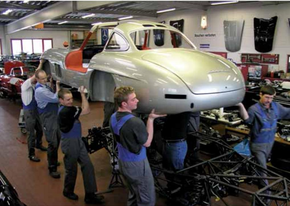
*Die Hochzeit steht an: Mit viel Fingerspitzengefühl setzen die Mechaniker Karosserie und Fahrwerk zusammen.*
