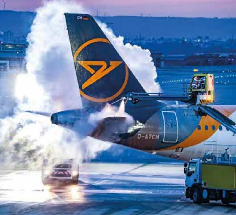
Der Mix macht's: Um Flugzeuge eisfrei zu halten, besprüht man sie bei Kälte mit biologisch abbaubarem Enteisungsmittel. Dank moderner Geräte kann der Cocktail am STR besonders maßvoll dosiert und – je nach Wetterbedingung – mit Wasser verdünnt werden.
