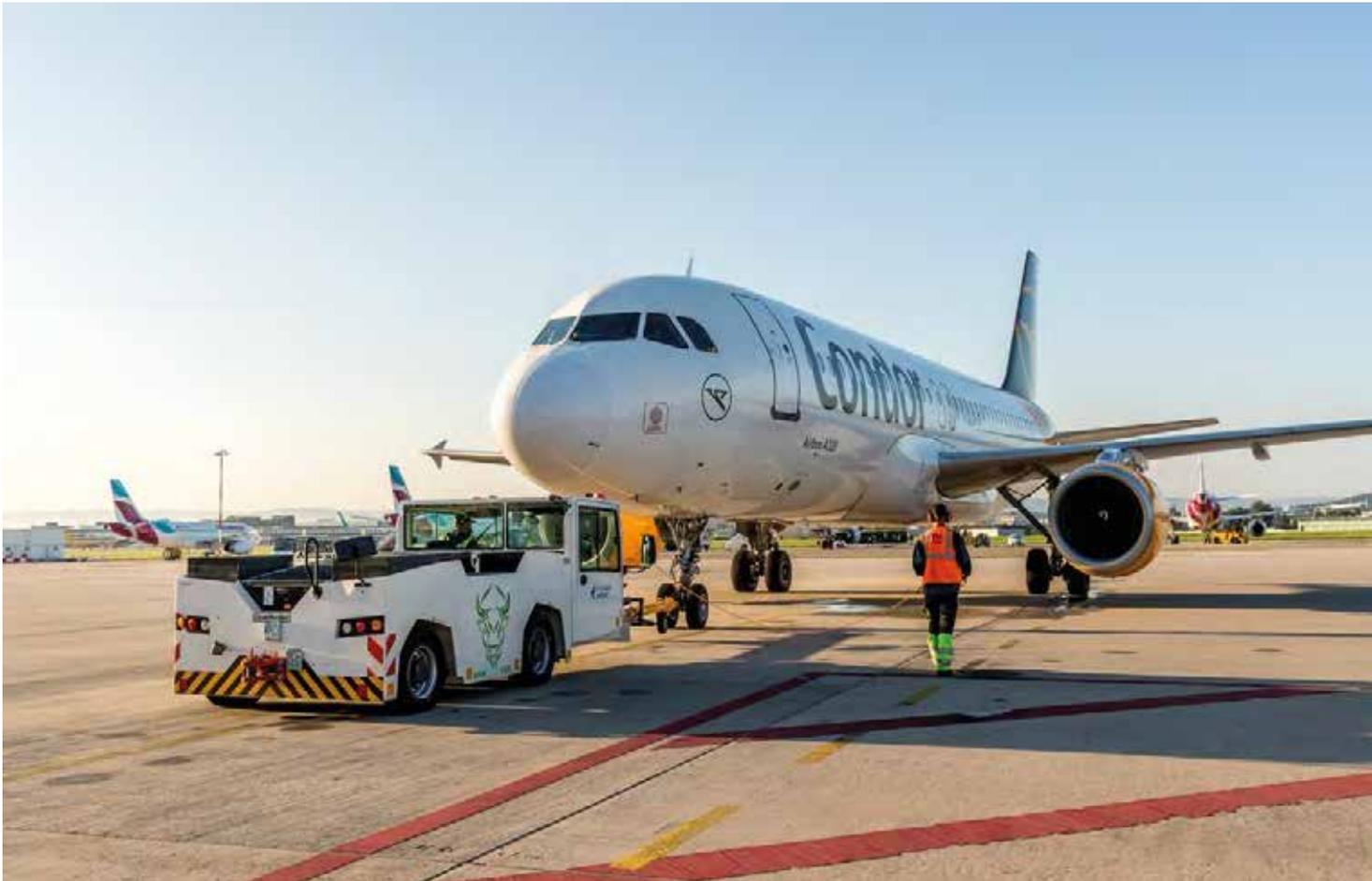
Da ein Flugzeug nicht rückwärtsfahren kann, schieben Schlepperfahrzeuge es an der Nase aus der Parkposition. Am STR übernimmt diesen Job ein Bison, ein batterieelektrisches Pushback-Fahrzeug.
