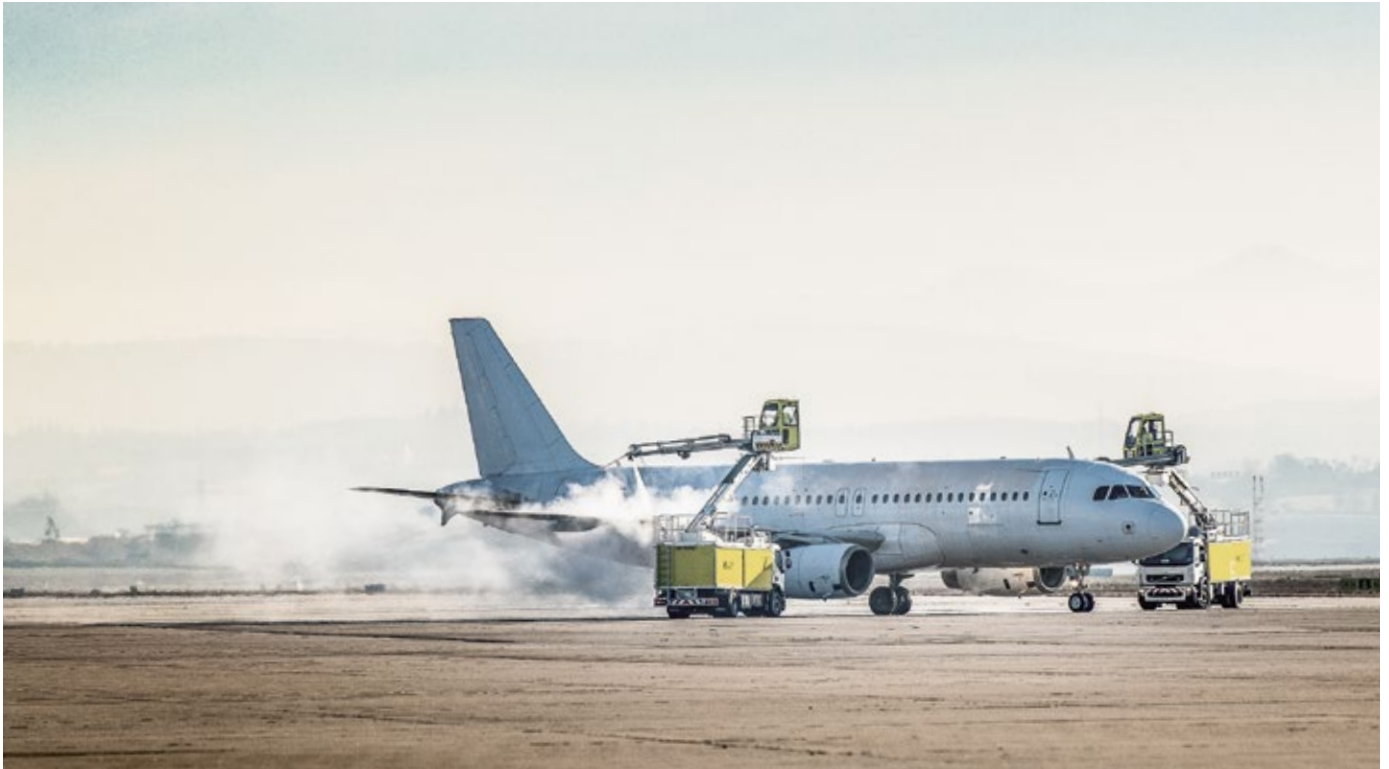
An der Flugzeug- und Flächenenteisung führt bei kalten Temperaturen kein Weg vorbei. Die Flughafengesellschaft hat alle nötigen Vorkehrungen getroffen, damit die eingesetzten Mittel nicht unkontrolliert in die umliegenden Gewässer gelangen können.
