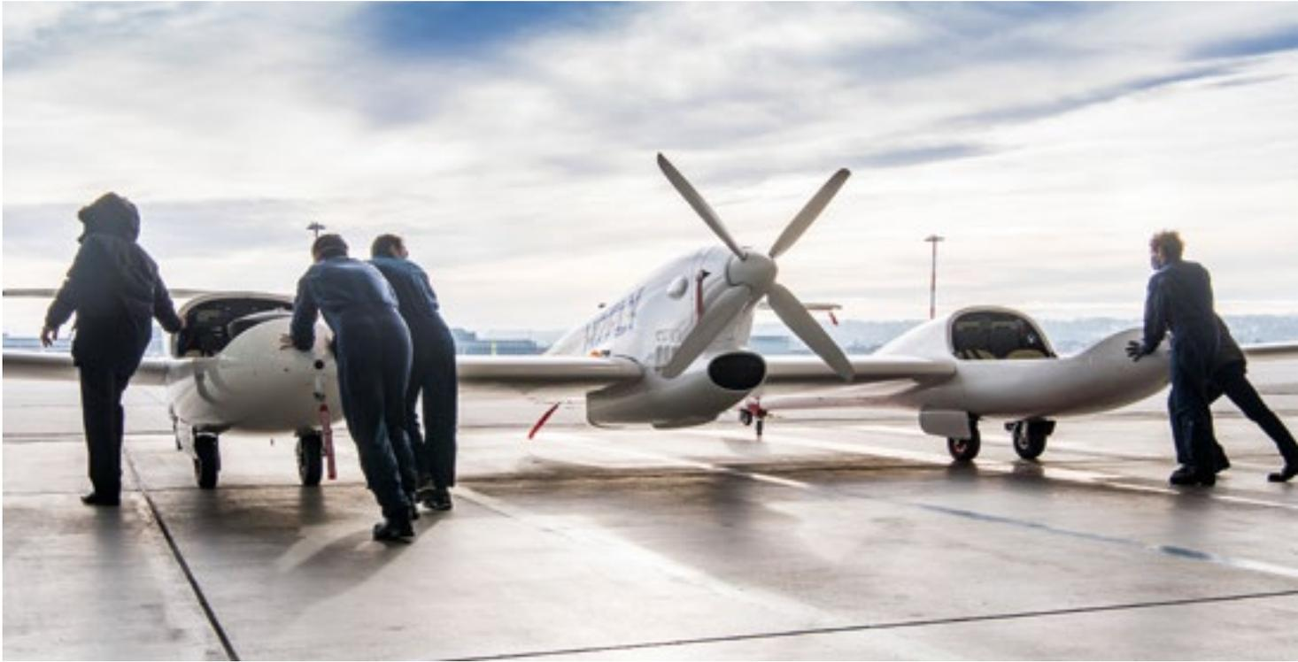
Mit aller Kraft arbeitet ein Entwicklerteam am STR an der Vision vom emissionsfreien Abheben. Das Antriebssystem der Hy4, das Wasserstoff-Brennstoffzellenflugzeug der Firma H2FLY, soll schon bis 2030 einen Vierzigsitzer in die Luft bringen können.
