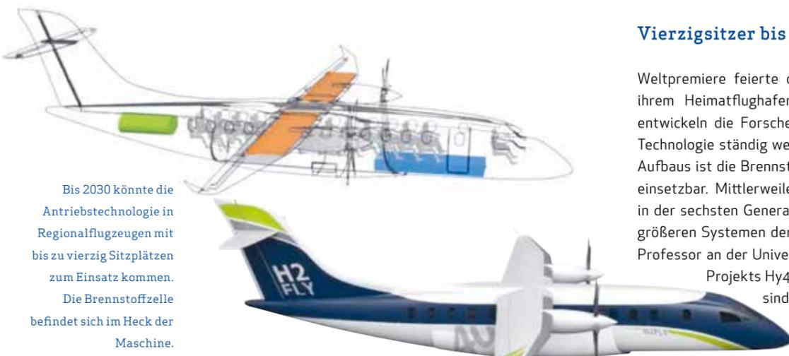
Bis 2030 könnte die Antriebstechnologie in Regionalflugzeugen mit bis zu vierzig Sitzplätzen zum Einsatz kommen. Die Brennstoffzelle befindet sich im Heck der Maschine.
