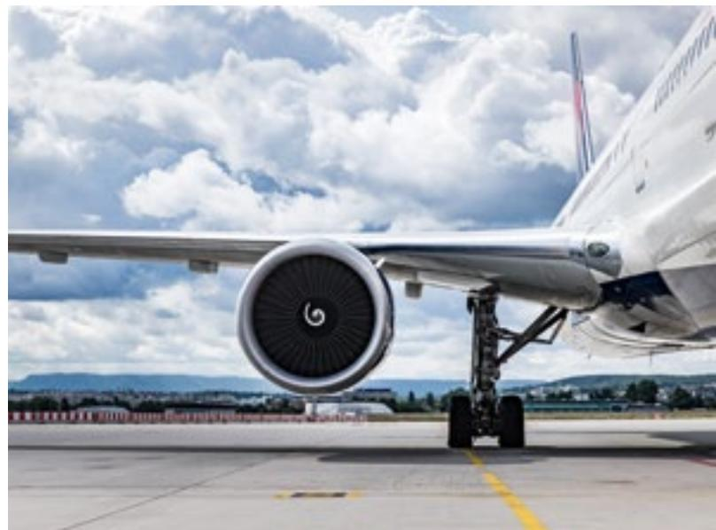
Laufende Turbostrahl-Triebwerke saugen vorne Luft an und blasen diese hinten wieder aus. Das sorgt für den nötigen Schub, erzeugt aber auch Lärm.
