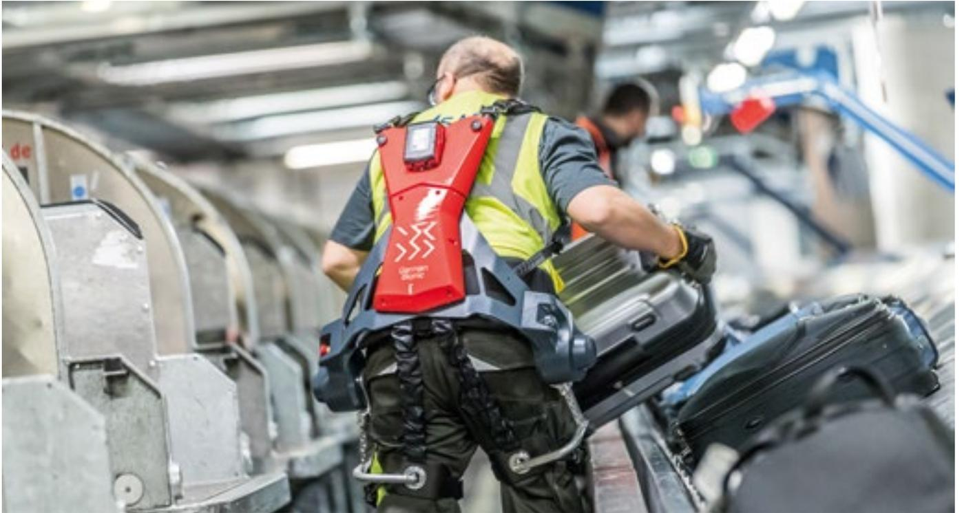
Offen für Neues: Als erster Airport in Europa setzen wir die Exoskelette eines Augsburger Start-ups beim Gepäck-Handling ein. Die Geräte unterstützen die Bewegungen des Trägers. So benötigen unsere Mitarbeiter beim Heben weniger Kraft und ihr Rücken wird entlastet.
