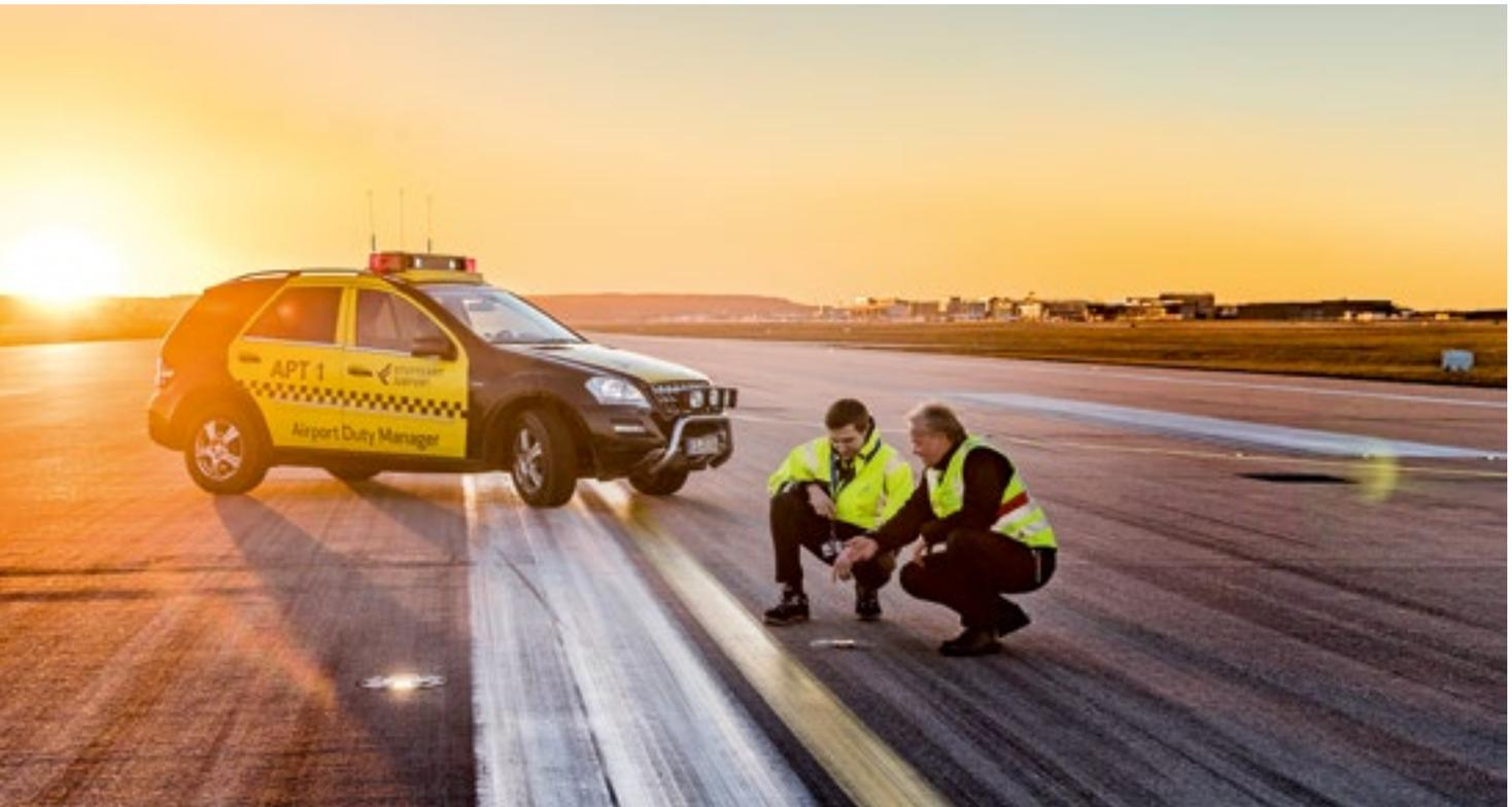
Bei der Luftverkehrssicherheit geht der STR keine Risiken ein. Mindestens sechsmal am Tag fahren die Airport Duty Manager nach Freigabe des Towers die Runway sowie die Rollwege ab und überprüfen sie auf mögliche Schäden.
