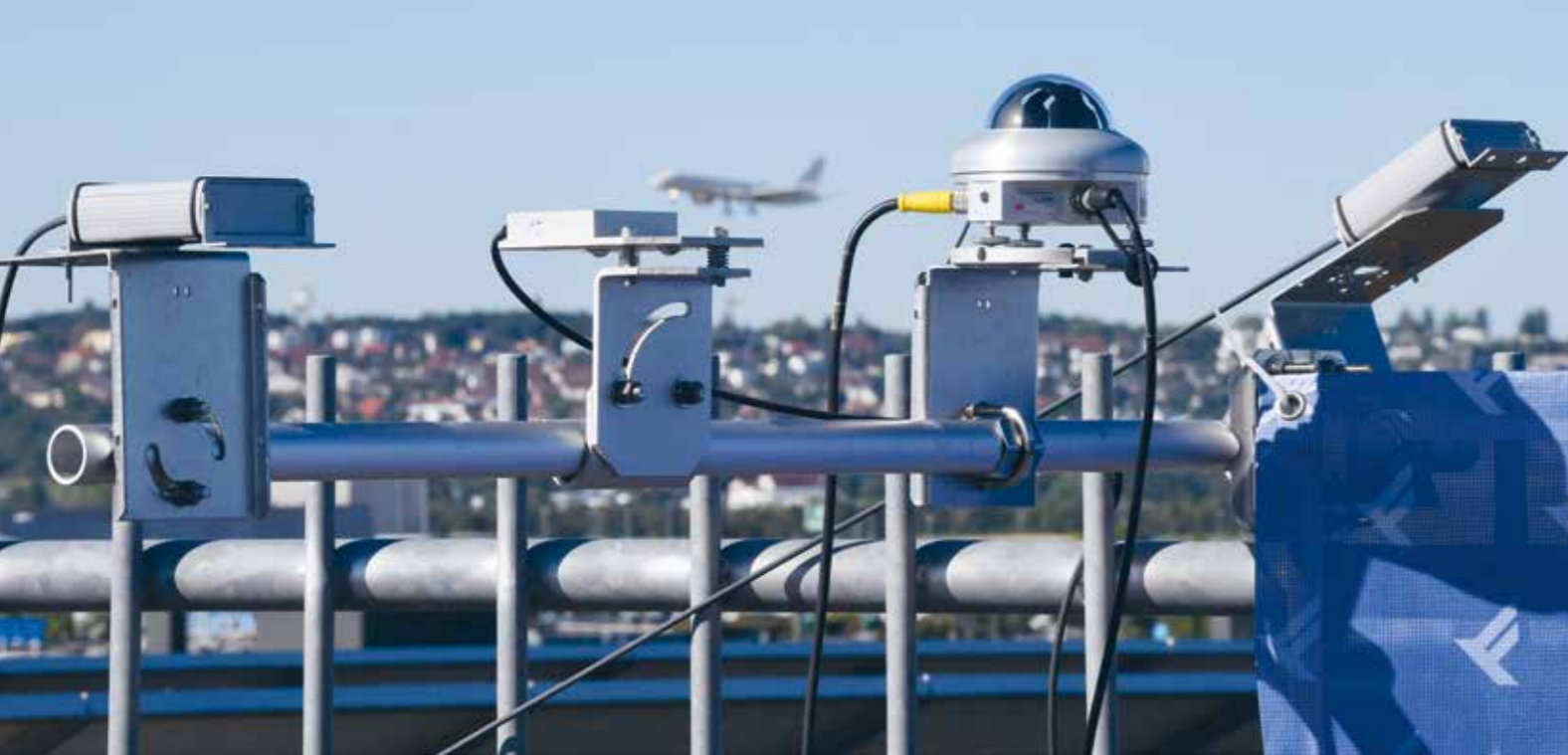
↑ Unter der Glaskuppel des sogenannten Pyranometers werden wichtige Daten zur Bestrahlungsstärke der Sonne gesammelt.
