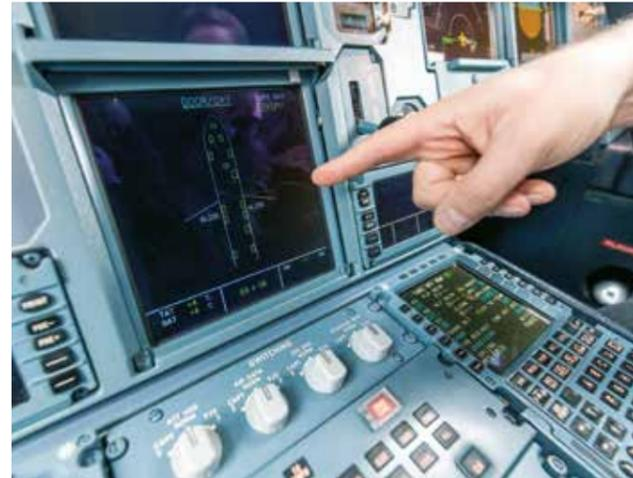
↑ Alles im grünen Bereich: Die farbigen Rechtecke auf dem System Display zeigen hier an, dass die Türen der Maschine geschlossen sind.
