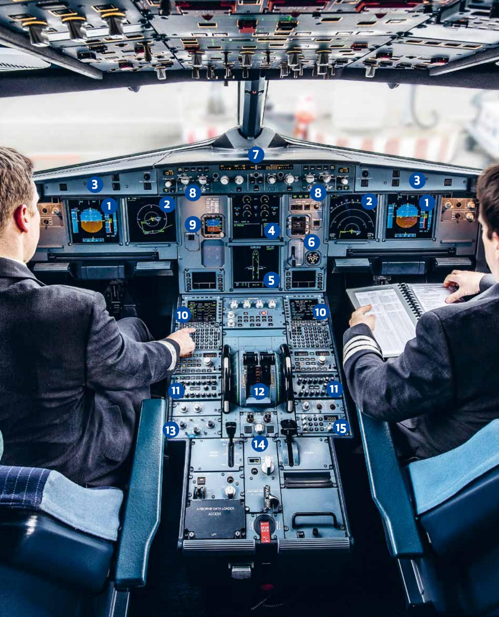
**8** Der Luftdruck für den Höhenmesser wird über das **elektronische Fluginstrumentensystem (EFIS)** eingestellt. Zur Orientierung im Luftraum können die Piloten über Druckknöpfe die Anzeige auf dem Navigation Display ändern und beispielsweise Flughäfen einblenden lassen.
