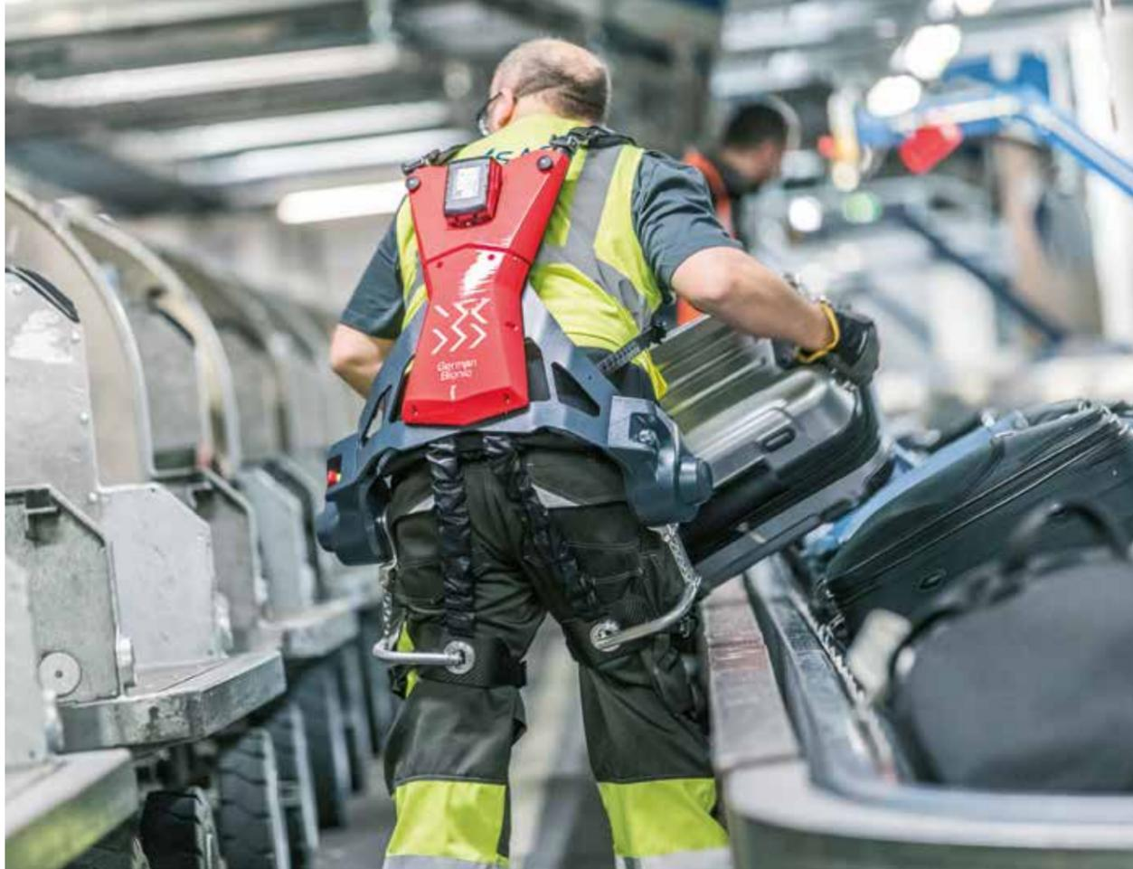
Keine Rettungsweste, hilft aber trotzdem: Das Exoskelett auf dem Rücken von Simone Domenico ist vollgestopft mit Sensoren sowie Elektronik und unterstützt Mitarbeiter am STR beim Gepäck-Handling.
