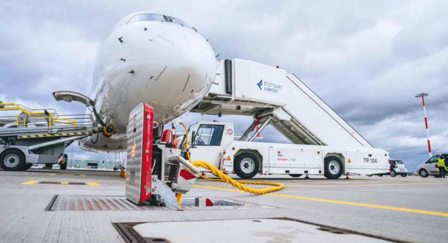
Während die Triebwerke stillstehen, sorgen diese neuen Trafo-Stationen am STR für Power an Bord.
