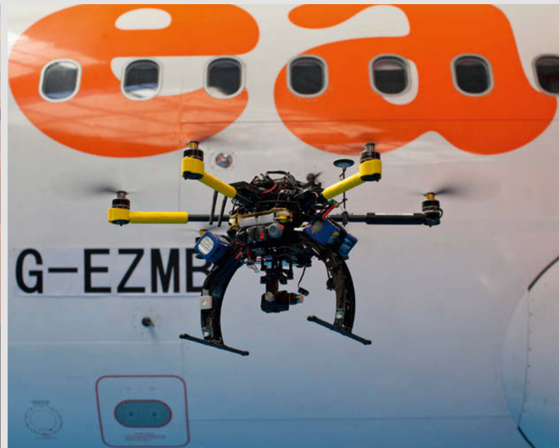
Drohenauge sei wachsam! Die kleinen Fluggeräte suchen im Auftrag der Easyjet-Techniker die Maschinen nach äußeren Beschädigungen ab.
