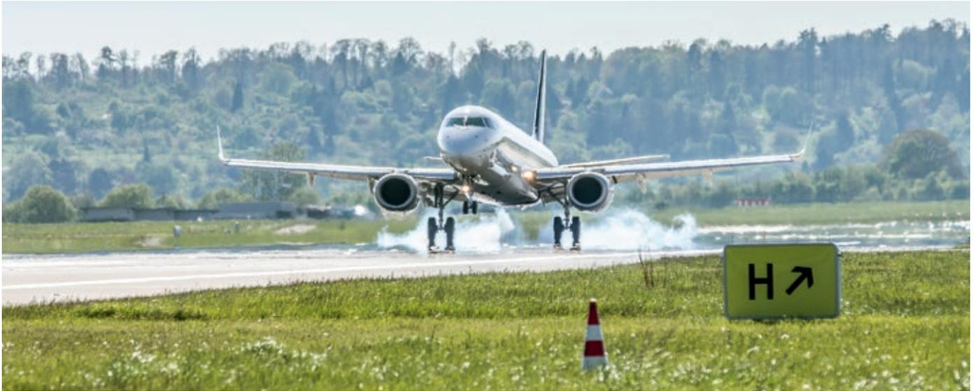
Beim Touchdown hinterlassen Flugzeuge schwarzen Belag auf der Start- und Landebahn. Damit die Maschinen immer sicher landen können, wird dieser zwei- bis dreimal im Jahr entfernt. Gut 700 kg Gummibrieb kommen da zusammen – und werden als Wertstoff sortenrein getrennt.
