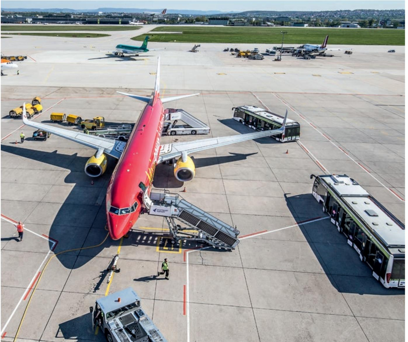
Abfertigung ohne Abgase – Elektrobuss, solarbetriebene Passagiertreppen, E-Förderbänder und -Gepäckschlepper senken die lokalen Emissionen (siehe Im Fokus, Seite 36).
